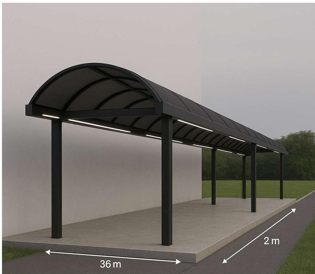
**Cobertura com Estrutura Metálica e Policarbonato Semi-Arqueado em Tom Escuro, Iluminação em LED e um Passeio Público de 1,50 m 20 cm de Espessura com Caimento**
