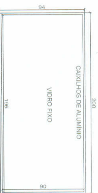
JANELA 2,00mx0,94m VIDRO FIXO 8 UNIDADES MODELO 02
